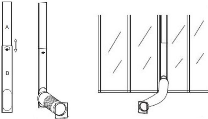
**UNSER TIPP:** Falls Sie keine Öffnung in die Wand/das Fenster machen wollen/können, empfehlen wir, eine Fensterdichtung für Klimaanlage zu kaufen oder die wie folgt vorzugehen: Öffnen Sie ein wenig die Balkontür oder das Fenster so, dass der Abluftschlauch nach außen herausgeführt werden kann. Durch das Zuziehen der Vorhänge oder der Außenjalousien eliminieren Sie den Eintritt der warmen Luft von außen.
